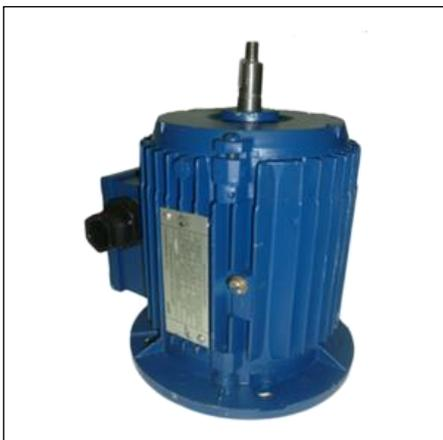
Электродвигатели для обдува трансформаторов АБ63А4ВУ1 (УХЛ1) и АБ63В4ВУ1 (УХЛ1) предназначены для работы от трехфазной сети переменного тока частотой 50 Гц, для привода осевого вентилятора системы охлаждения мощных трансформаторов при значении климатических факторов согласно ГОСТ15150-69.
