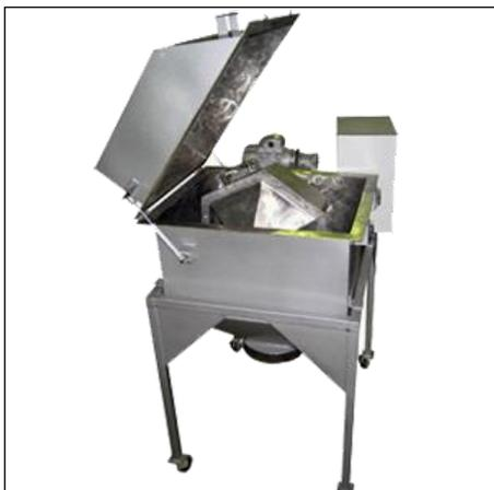
Предназначена для перемешивания сухих материалов, жидкостей и смеси жидкости с сухим материалом.
