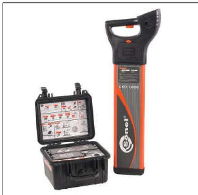
Трассопоисковая система «LKZ-1000» позволяет проводить поиск и определять глубину прохождения кабельных линий, элементов тепло- и водоснабжения (в том числе пластиковых труб). Определение глубины залегания объектов до 3 метров. Возможность подключение генератора к объектам под напряжением (индукционный метод) или использование вспомогательных трассопоисковых кабелей и зондов для более точного определения трассы и глубины залегания.
